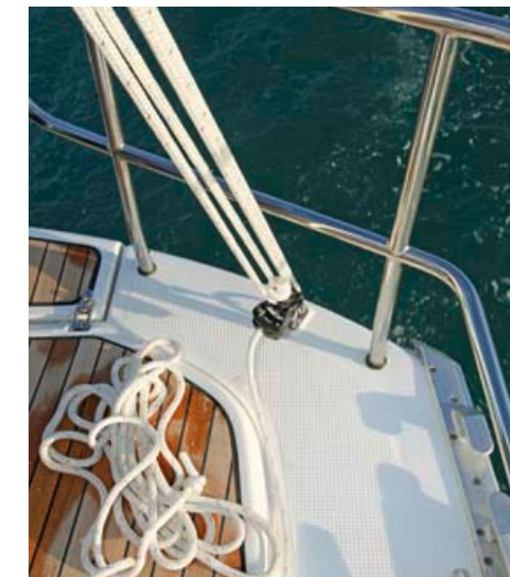
Napetost krmne pripone nastavljamo s pomočjo škripca.
